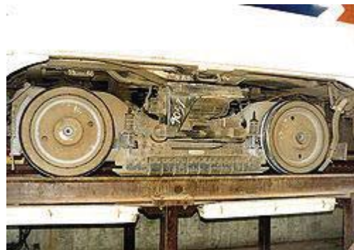
Рисунок 1 – Електромагнітні рейкові віхорострумні лінійні гальма філадельфійського трамваю РСС
