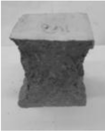
Рисунок 4 – Образец после испытания на прочность при сжатии
