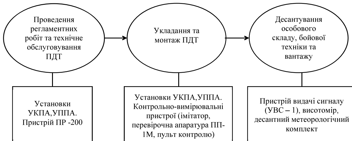
Рисунок 1 – Схема метрологічного забезпечення під час проведення підготовки та десантування людей, техніки та вантажів
