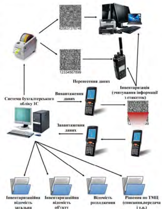
Рис. 3. Система інвентаризації за допомогою комп'ютерної техніки з використанням технології штрихового коду
