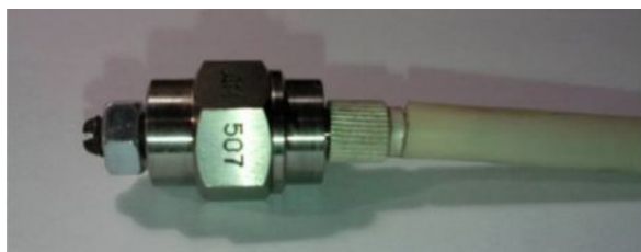
Рис. 1. Зовнішній вигляд датчика Д14.507 зі з'єднувальним екранованим дротом
