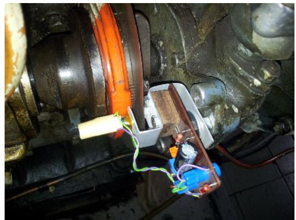
Рис. 5. Кріплення оптичного датчику ВМТ поршня 1-го циліндру на приводі паливного насосу високого тиску
