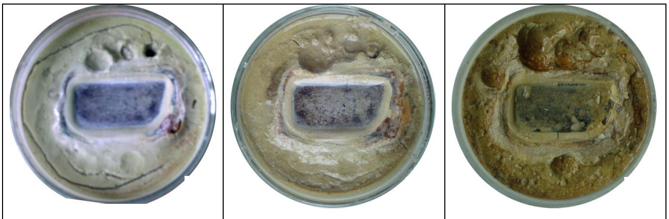
Рис. 5. Зовнішній вигляд пластини вуглецевої сталі у контакті з бентонітом. А – через 5 місяців; Б – 7 місяців; В – 14 місяців.
