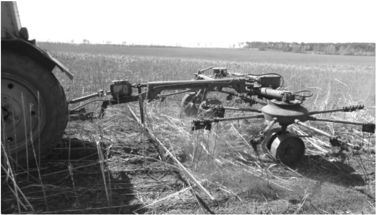
Рис. — Зламуючо-згрібальний агрегат для згрібання трести конопель весняного збирання в роботі.
