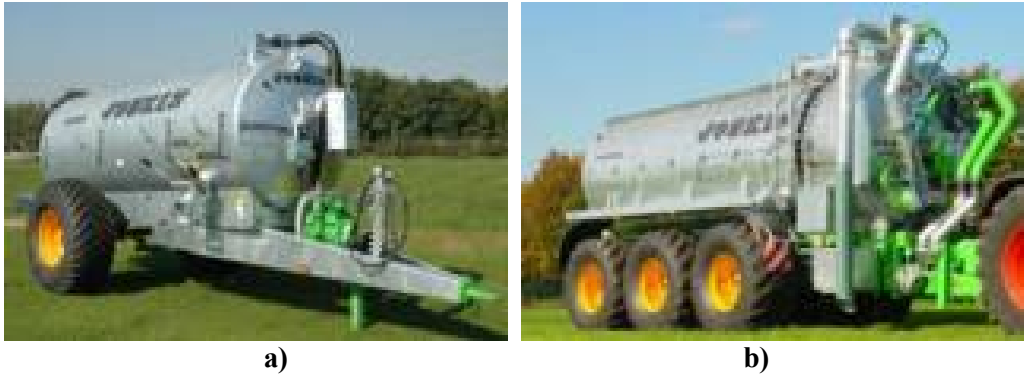
Рис. 4. Агрегат для внесення рідких органічних добрив - «Joskin»: а) ємність 6 м 3 , б) ємність 24 м 3 ( http://www.joskin.com )
