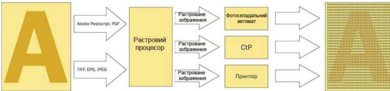
Рис. 2. Спрощена схема роботи процесора растрових перетворень
