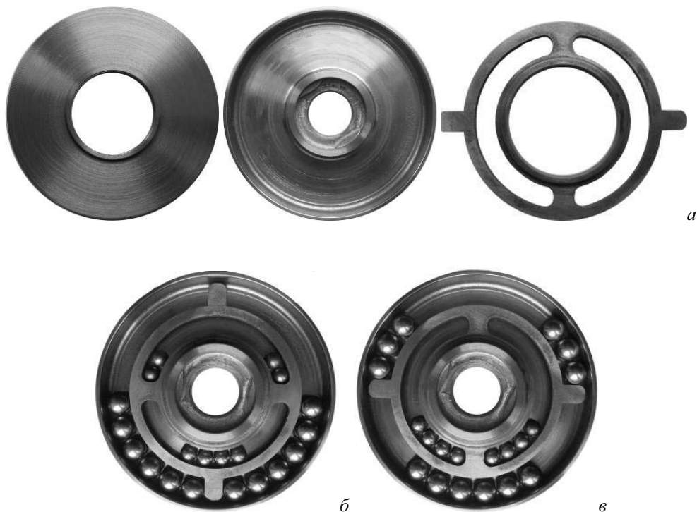
а - деталі, б – положення куль при максимальній балансувальній ємності, в – положення куль при мінімальній балансувальній ємності
