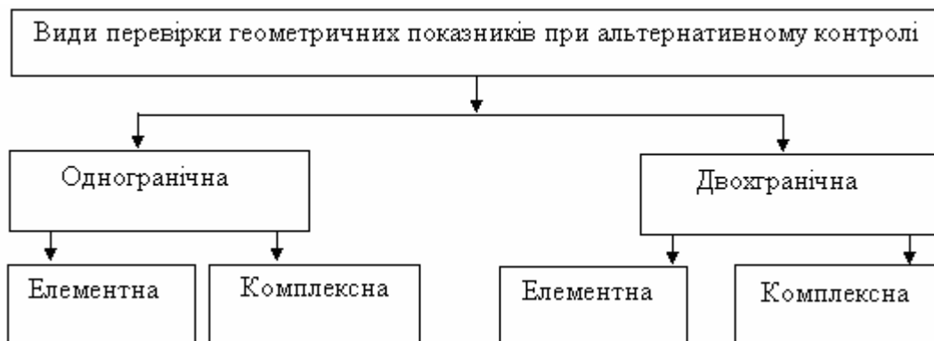
Рисунок 4 - Класифікація видів перевірки геометричних показників при альтернативному контролі
