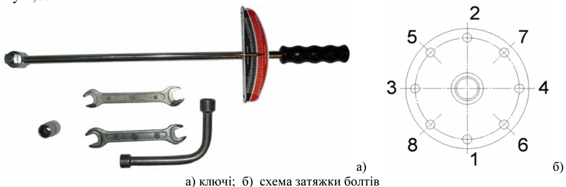
Рисунок 4 – Ключі та схема затяжки болтів елементів роторного комплексу
