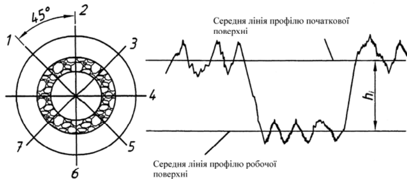
Рисунок 2 - Схема вимірювання зносу зразків після випробування на ФК
