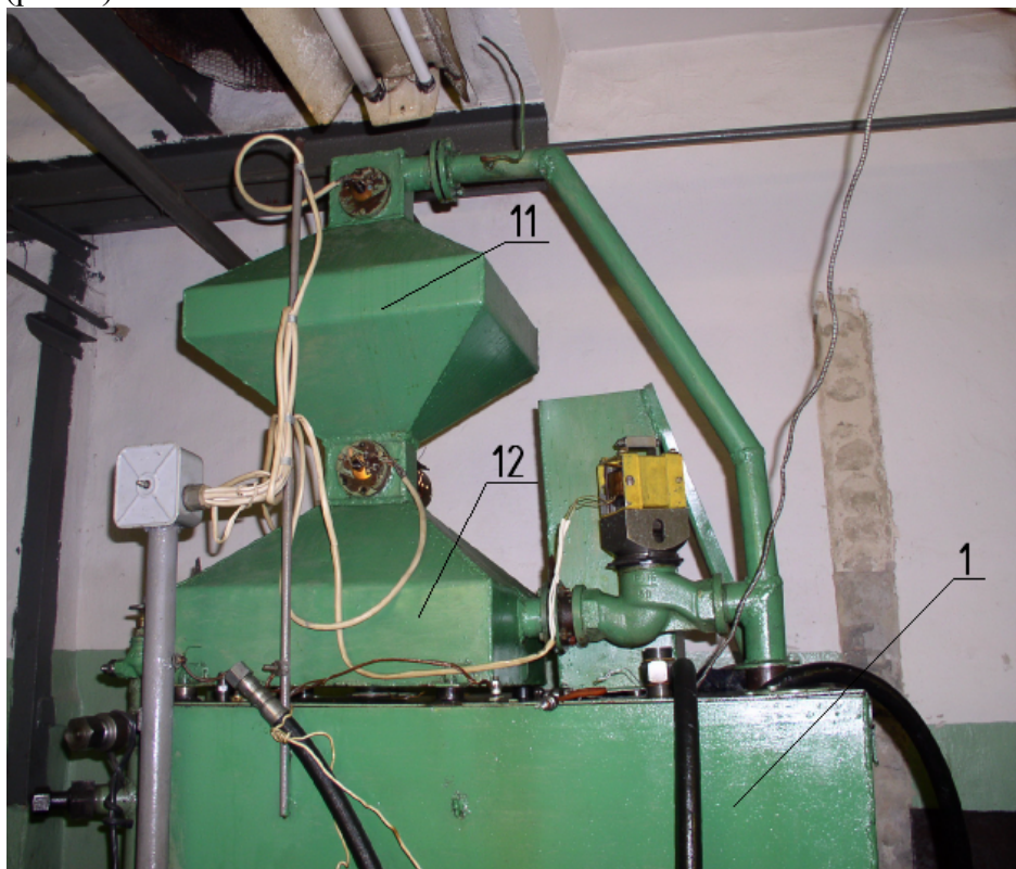
1- загальний бак; 11- мірний бак, 12 - прийомний бак
