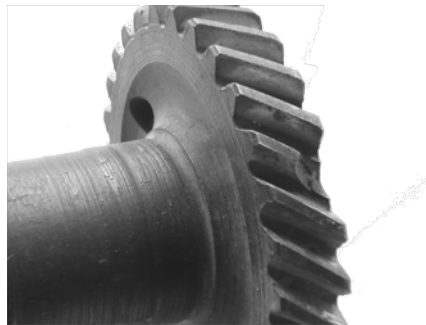
Рисунок 2 – Приклад поломки зуба косозубого колеса
