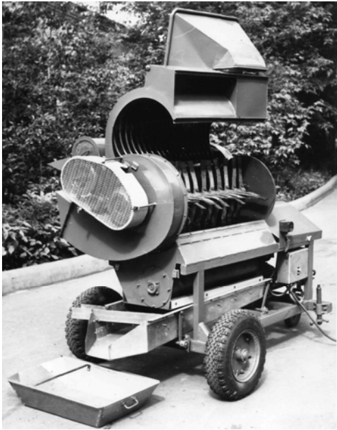
Рисунок 1- Молотилка МСУ-1, оборудованная барабаном с эластичными бичами
