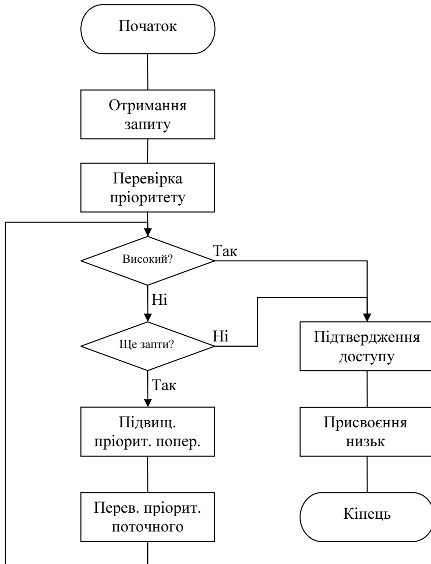
Рисунок 3 – Блок-схема роботи системи пріоритетів
