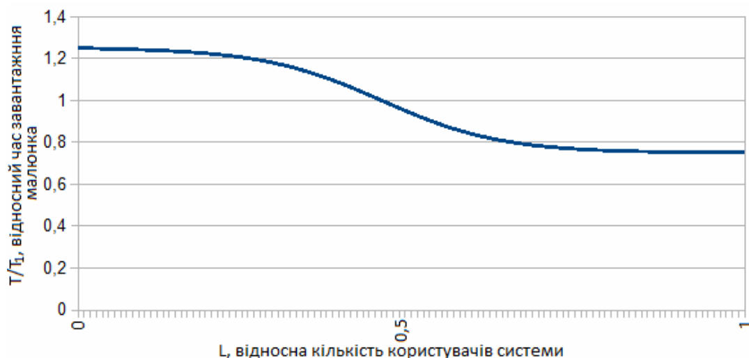
Рисунок 2 – Зміна оперативності системи зі збільшенням кількості користувачів ( T_1=T_3 , T_2=T_1/4 )
