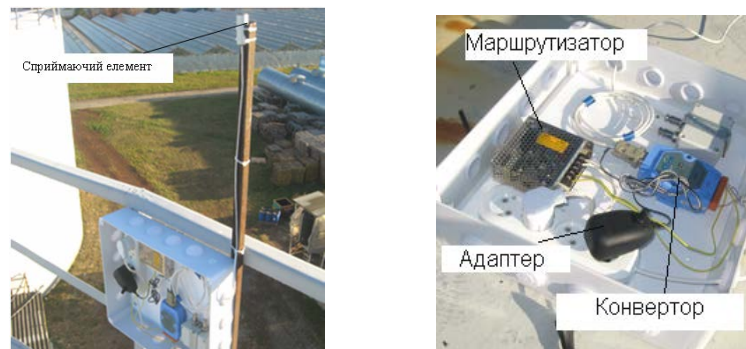
Рисунок 1 – Інформаційно-вимірювальна система інтенсивності сонячної радіації та зовнішньої температури повітря
