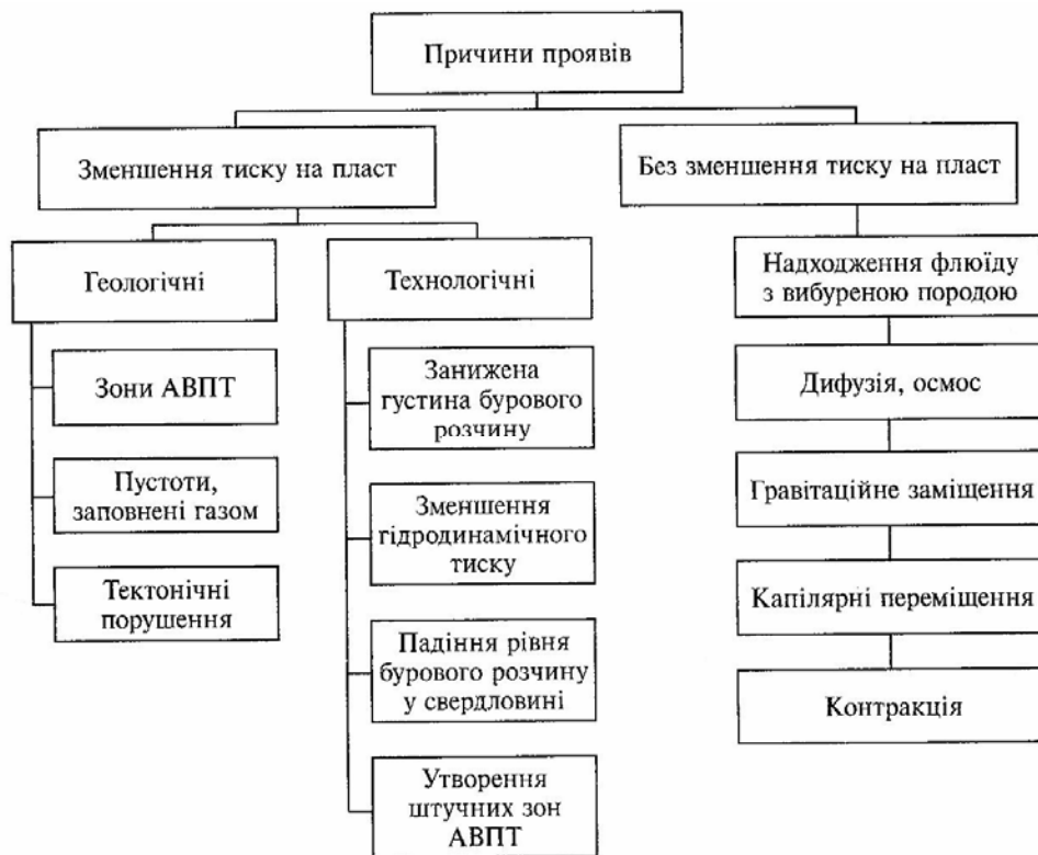
Рисунок 1 – Систематика причин флюїдопроявів у процесі буріння
