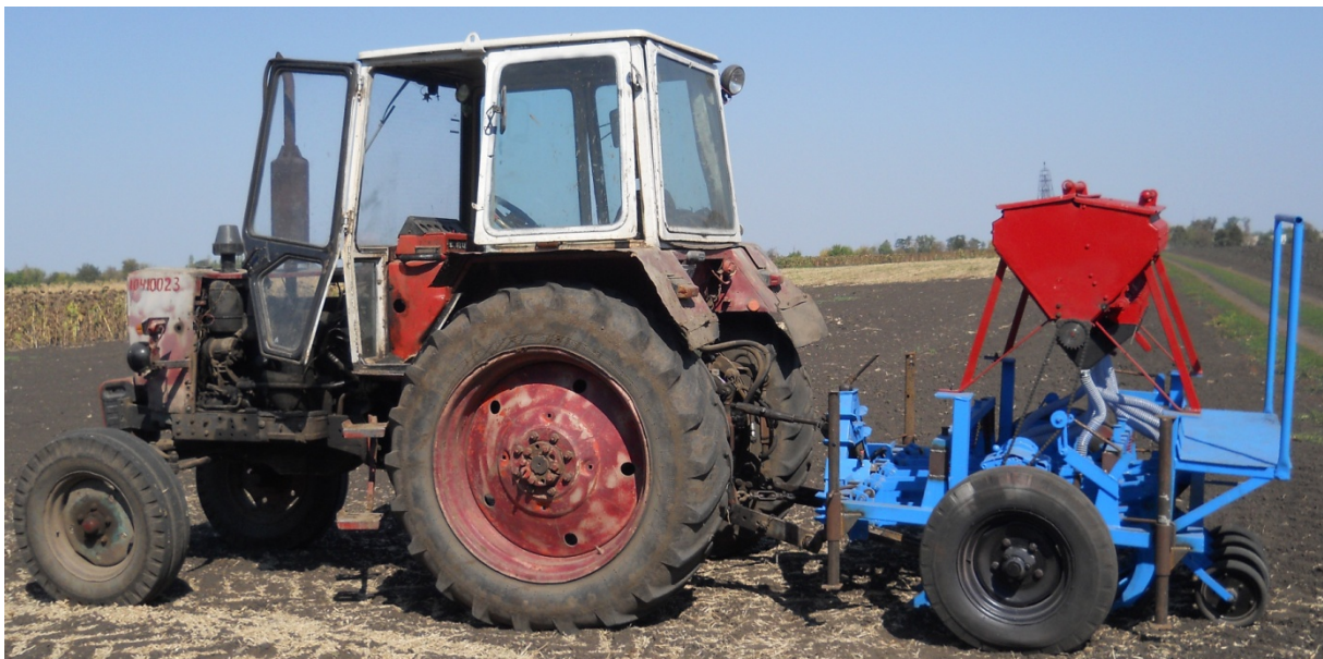
Рисунок 1 – Загальний вигляд посівного агрегату з експериментальною селекційною сівалкою прямого посіву ССПП-1,5
