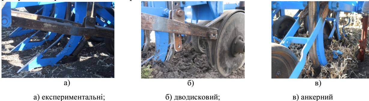
Рисунок 2 – Сошники, встановлені на експериментальній сівалці
