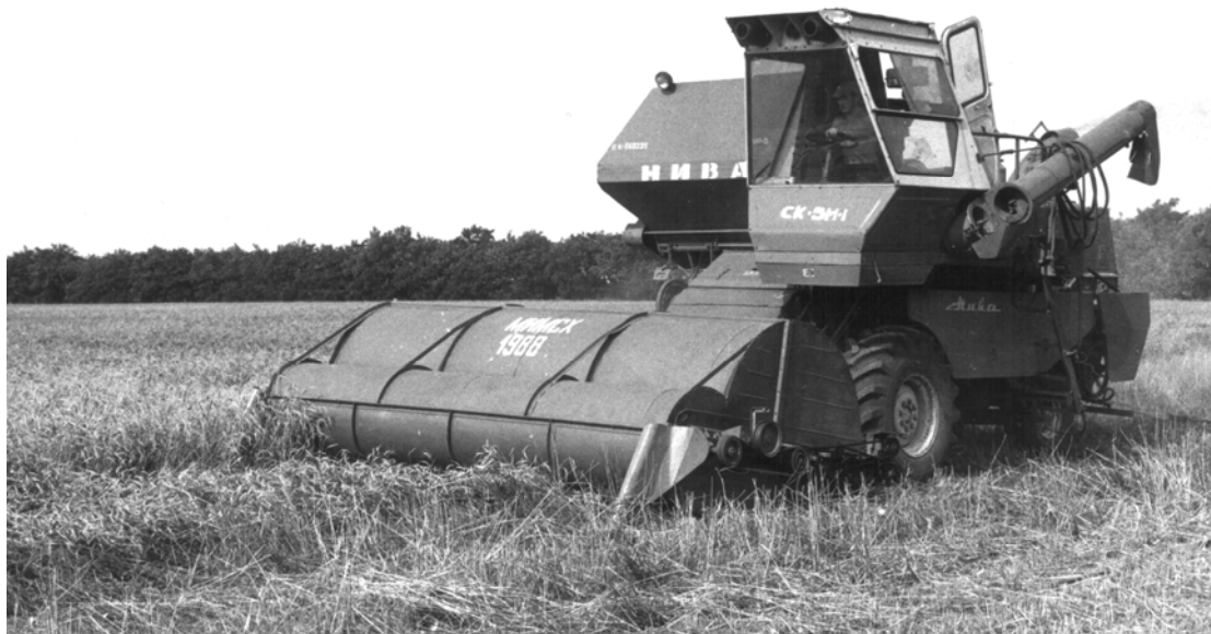
Рисунок 1 – Общий вид очесывающего устройства МОН-4,0 конструкции МИМСХ
