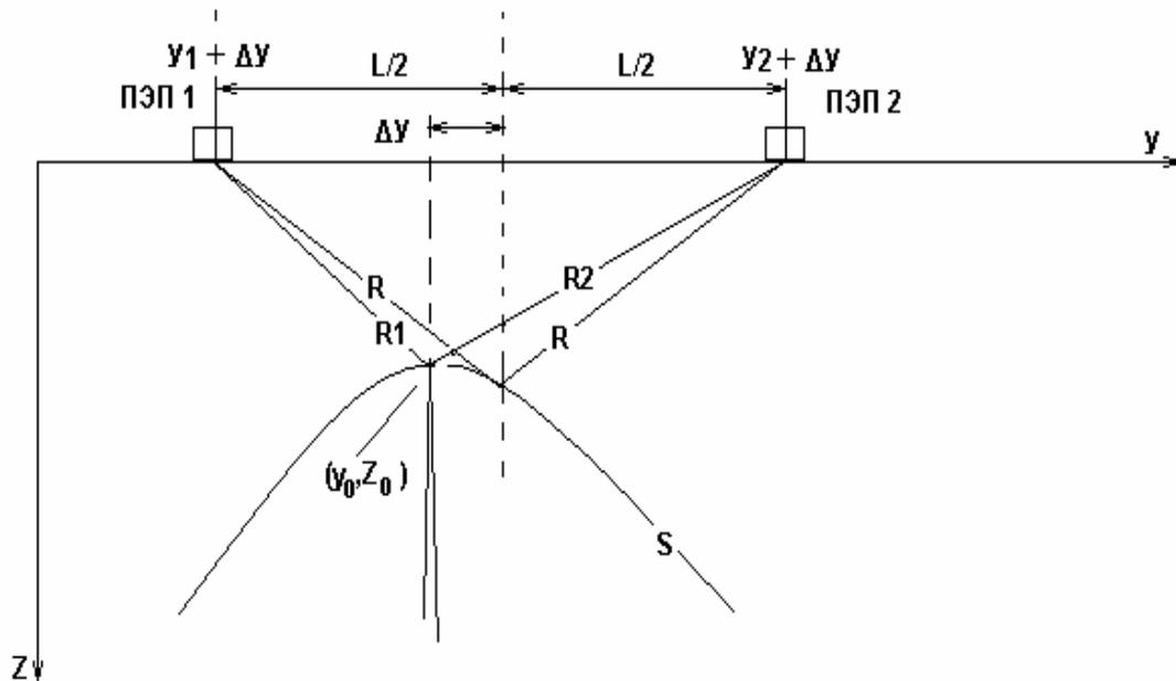
**S** - Рассчётный "след" вершины трещины с координатами  $(y_0, z_0)$ ;
