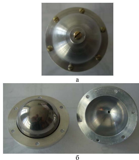
а – зовнішній вигляд демпфера; б – деталі демпфера Рисунок 2 – Дослідний зразок інерційного демпфера рідинного тертя
