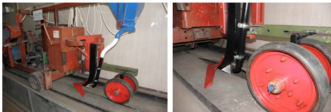
Рисунок 2 – Загальний вигляд експериментальної установки в ґрунтовому каналі
