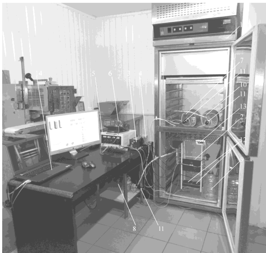
1 – морозильна камера; 2 – аеробокс; 3 – універсальний вимірювач-регулятор; 4 – блок проміжних реле; 5 – лабораторний блок живлення; 6 – прецизійний мультиметр; 7 – ємність з холодоносієм; 8 – ємність з теплоносієм; 9 – ємність для відпрацьованих холодо/теплоносіїв; 10 – ємність з дистильованою водою; 11 – відцентрові електронасоси; 12 – осьові вентилятори; 13 – фотобокс; 14 – персональний комп'ютер та додатковий монітор
