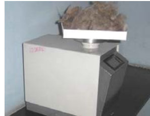
б) зважування зразка вовни ( m=100\text{г} )
