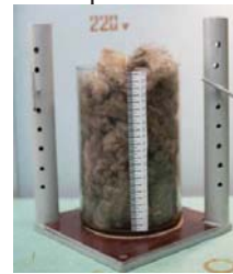
д) завантаження зразка в циліндр
