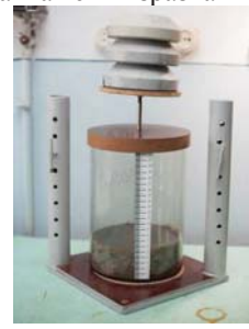
ж) встановлення вантажу ( G_i )
