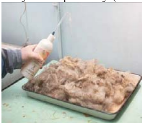
в) зволоження зразка вовни (до W_i )
