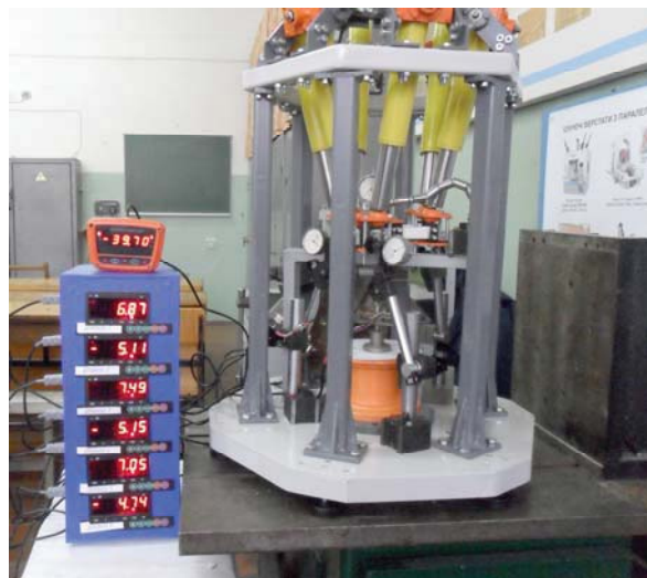
Рисунок 3 – Визначення крутного навантаження по вісі симетрії МПС сумісно з осьовим навантаженням при компоновці 6 \times (3 \times 2)
