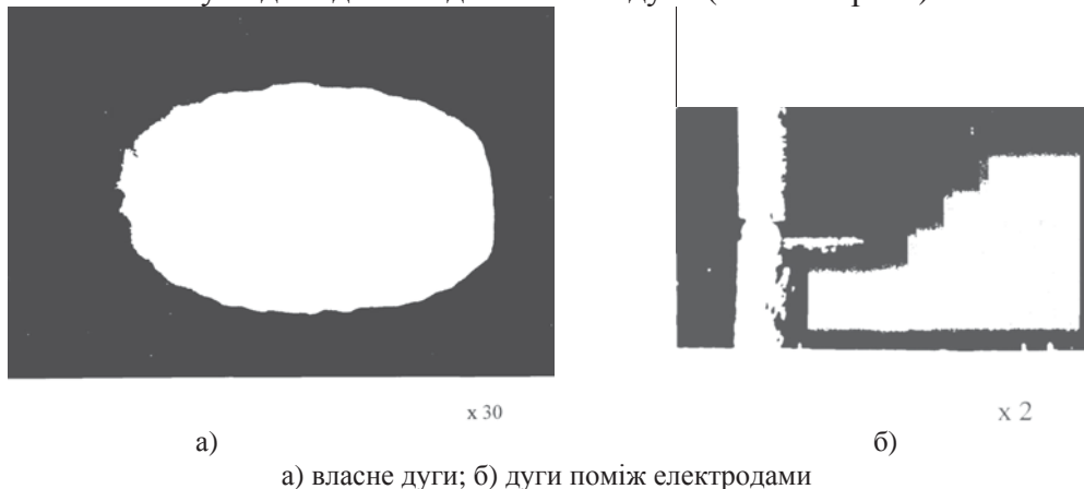
Рисунок 2 – Кадр швидкісної кінозйомки дуги
