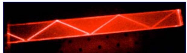
Рис. 3. Схема проходження променя в оптоволокну
