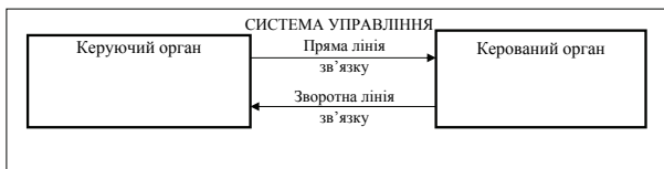
Рис. 2. Загальна схема організаційно-технологічного управління в автоматизованій системі
