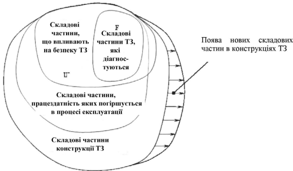
Рис. 1. Ілюстративне обґрунтування складу агрегатів, систем і вузлів, що діагностуються для забезпечення безпеки ТЗ, які експлуатуються
