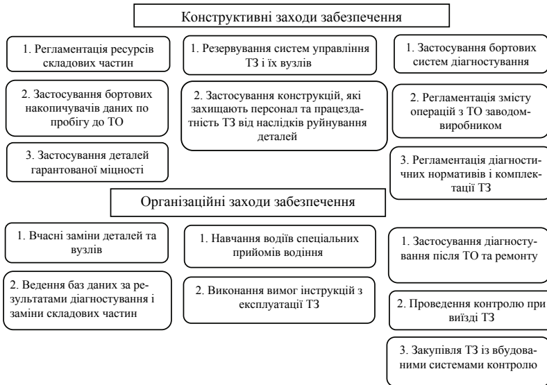
Рис. 3. Складові експлуатаційної властивості “захищеності ТЗ від небезпечних несправностей”, їх вимірювачі та заходи із забезпечення
