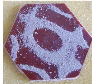
Рис. 4. Хвилі на шестигранній пластинці з гетинаксу
