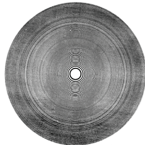
Рис. 7. Зонна пластинка для зеленого світла ( \lambda=0,55 мкм) з кількістю зон Френеля ( m=100 )
