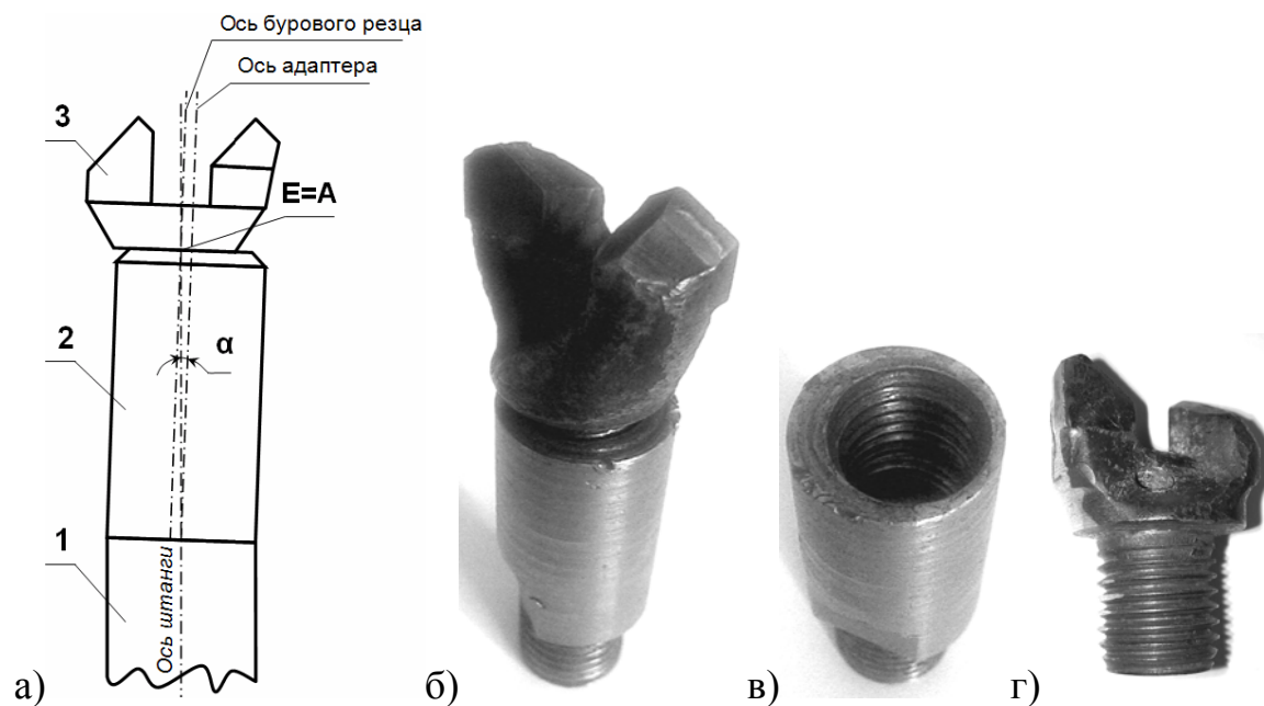
Рис. 2. Средства для управляемого профилирования стенок шпуров: а – схема специализированного бурового става; б – внешний вид в сборе; в – адаптер с эксцентриситетом; г – резец породный анкерный РПА-181.
