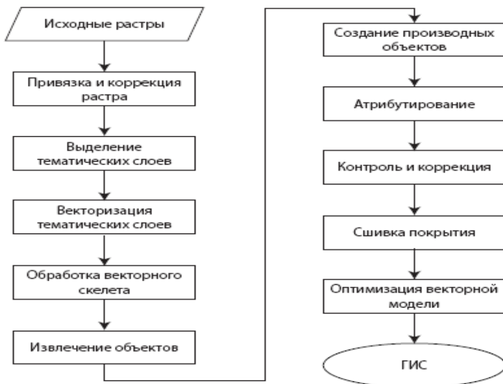
Рис. 3. Технологическая цепочка процесса векторизации космического снимка
