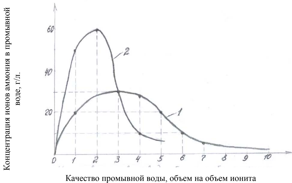
1 – непрерывный режим регенерации; 2 – порционный режим регенерации Рис. 3. Выходные кривые отмывки ионита от регенерации
