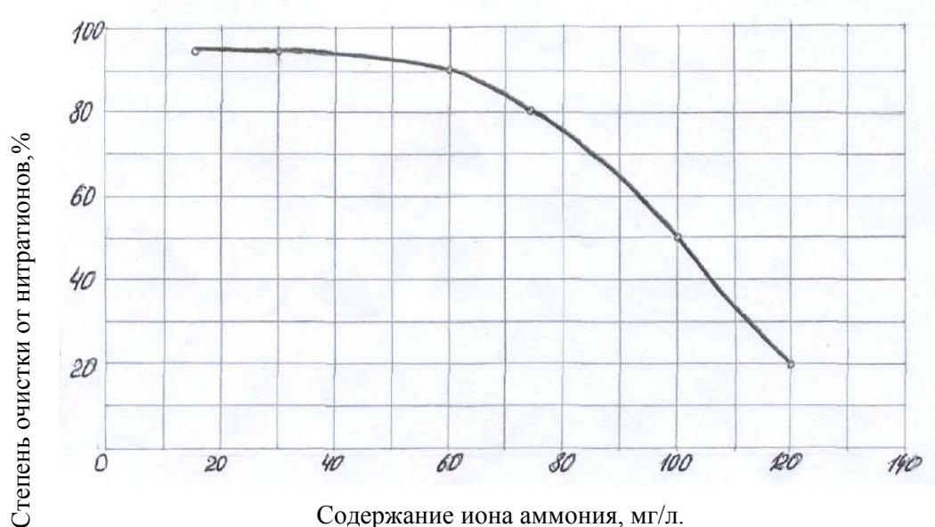
Рис. 1. Изменение степени очистки конденсата от нитрат-иона анионитом АН-22-8 в зависимости от содержания в растворе ионов аммония
