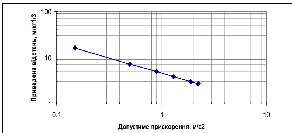
Рис.3. Залежність допустимих значень інтенсивності впливу СВХ на укоси (в одиницях прискорення) від приведеної відстані до допустимої маси групи зарядів, що одночасно підриваються ( \text{м/кг}^{1/3} )
