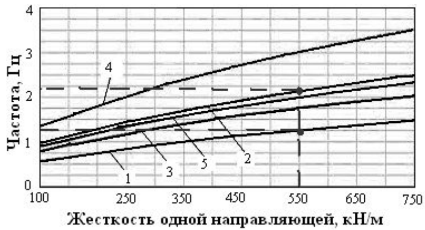
Рис. 2. Собственные частоты системы «скип – роликовые направляющие»: 1 – поступательная частота в лобовой плоскости; 2 – угловая частота в лобовой плоскости вокруг боковой оси инерции; 3 – поступательная частота в боковой плоскости; 4 – угловая частота в боковой плоскости вокруг лобовой оси инерции; 5 – угловая частота в боковой плоскости вокруг оси каната
