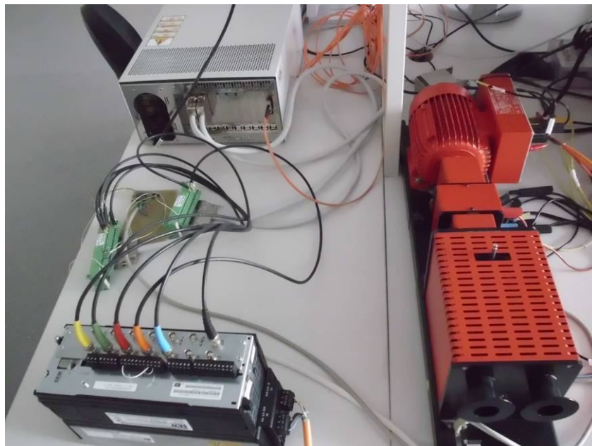
Рис. 4. Общий вид экспериментальной установки для тестирования векторного управления.
