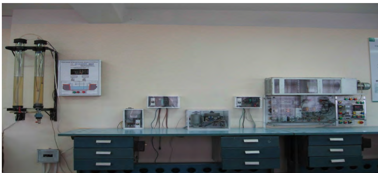
Рис. 2. Общий вид стендов: модели шахтного водоотлива; привода позиционирования поворотного затвора; теплового объекта с исполнительным механизмом интегрирующего типа; теплового объекта (слева направо)
