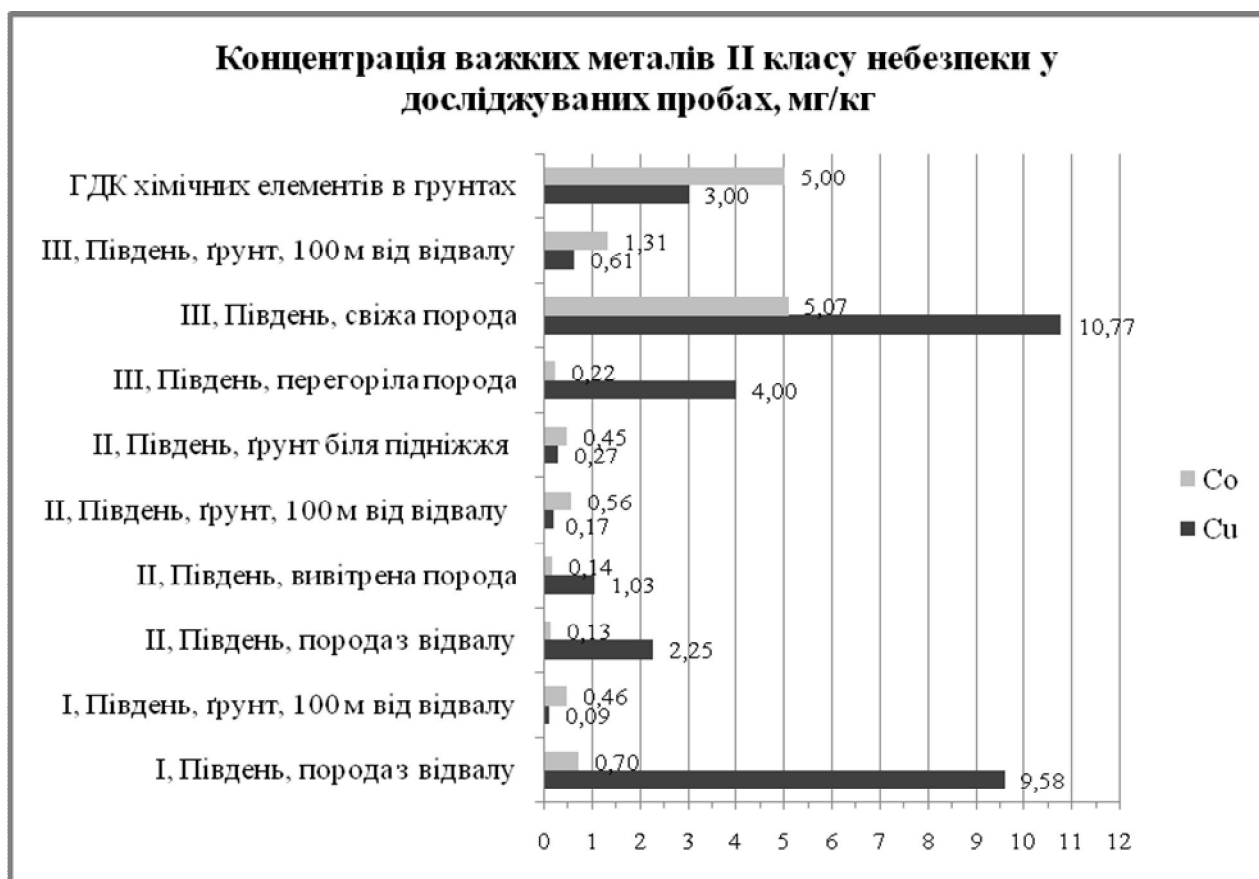
Рис. 2. Концентрації рухомої форми міді (Cu) та кобальту (Co) (I – відвал на стадії затухання внутрішніх та зовнішніх процесів, II – відвал на стадії затухання фізико-хімічних процесів за умов порушення цілісності тіла відвала та оголення внутрішніх порід, III – відвал на стадії затухання фізико-хімічних процесів за умов внесення свіжої відвальної породи)
