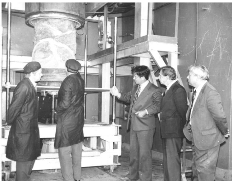
Рис. 7. Первая плавка в индукционной вакуумной печи с холодным тиглем
