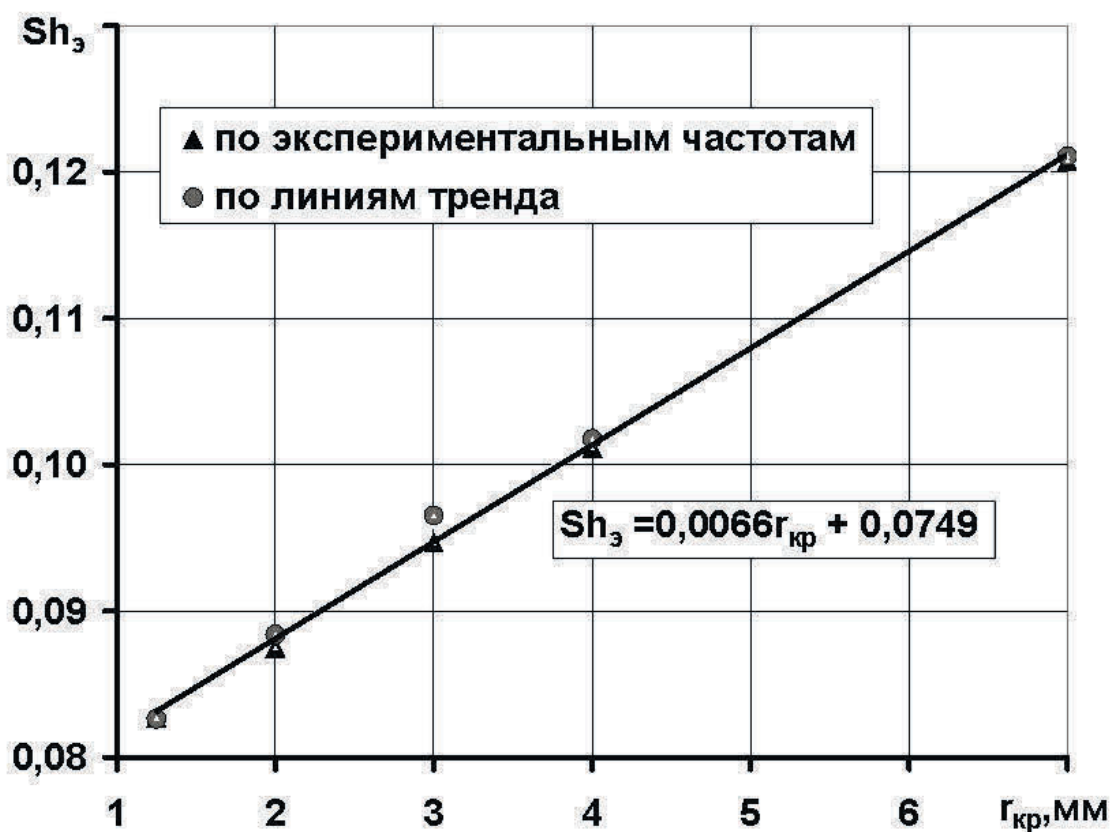
Рис.2. Зависимости числа Струхала Sh э от радиуса критического сечения генератора r кр
