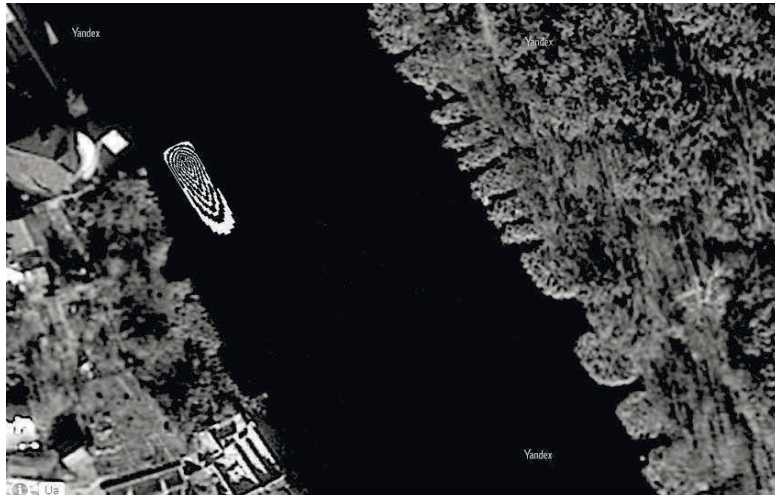
Рис. 2. Зона теплового забруднення для моменту часу t=56 хв після початку скиду стічних вод
