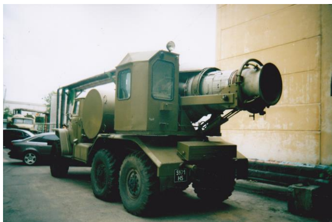
Рис. 1. Загальний вигляд установки ТМС-65
