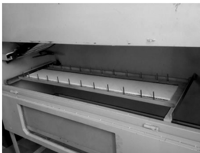
Рис. 5. Вигляд установки з дослідним зразком для визначення групи розповсюдження полум'я
