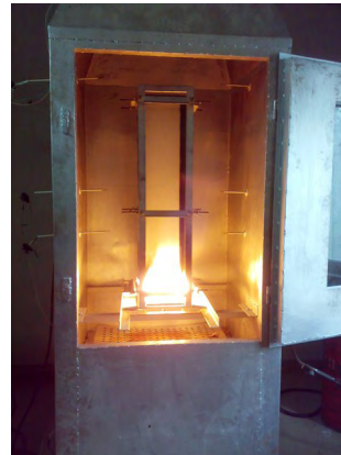
Рис. 3. Вигляд дослідного зразка та установки для визначення групи горючості
