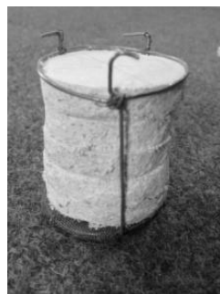
Рис. 1. Вигляд дослідного зразка для випробування на горючість
