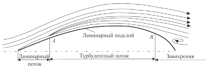
Рис. 3. Обтекание корпуса и изменения в пограничном слое
