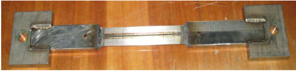
Рис. 12. Общий вид образца со сварным швом в захватах разрывной машины после испытания
