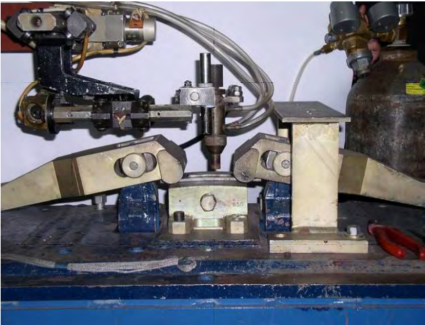
Рис. 5. Внешний вид установки динамического деформирования для реализации испытаний Varestraint-test
